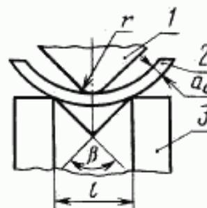
1 — оправка; 2 — поперечный образец; 3 — опора;
