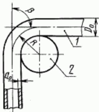
1 — образец-патрубок; 2 — цилиндрическая оправка;
